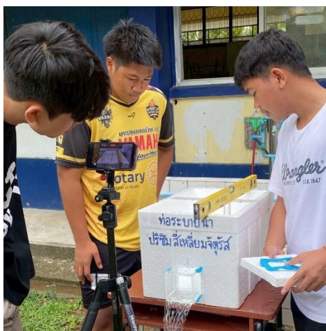
ภาพที่ 18 การทดลองของท่อระบายน้ำปริซึมสี่เหลี่ยมจัตุรัส
