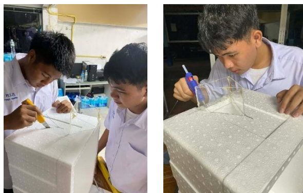
ภาพที่ 12 ติดท่อระบายน้ำปริซึมสามเหลี่ยมด้านเท่ากับภาชนะทดลอง
