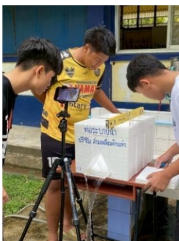
ภาพที่ 17 การทดลองของท่อระบายน้ำปริซึมสามเหลี่ยมด้านเท่า
