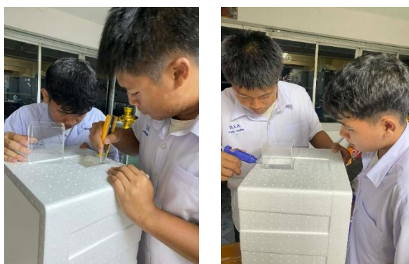
ภาพที่ 15 ติดท่อระบายน้ำปริซึมสามเหลี่ยมด้านเท่ากับภาชนะทดลอง
