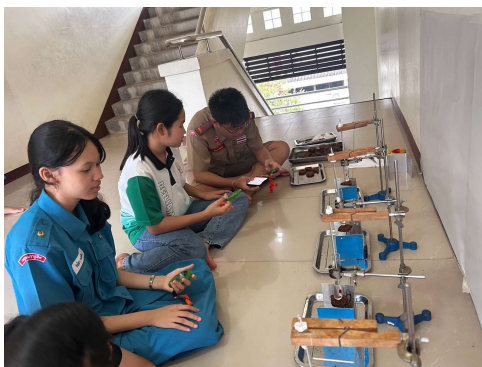
ภาพที่ 12 ภาพการจับเวลาและสังเกตอุณหภูมิของน้ำที่เพิ่มขึ้นจากการเผาไหม้ของแผ่นเชื้อเพลิง
